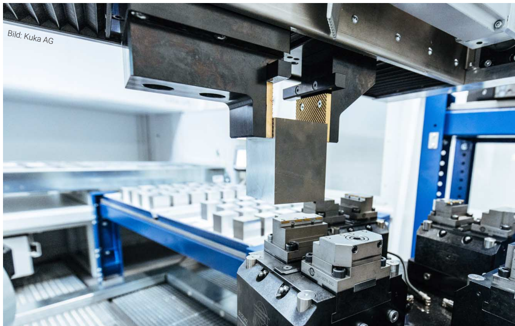
▲ Ein KR Quantec von Kuka übernimmt mit einem Greifer der Zimmer Group vollautomatisiert die Be- und Entladung der Bauteile.
