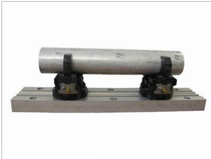
2 Stück BSM-140 mit Prismenbacken spannen eine Welle. Die Spanner können dabei wahlweise auf der Grundplatte verschoben werden. Somit können Wellen mit verschiedenen Längen und Durchmesser gespannt werden.
