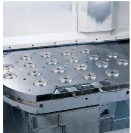
Spannmittel / Vorrichtungen mit Spannbolzen versehen
