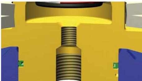
Patentierte düsenartige Ausblaspung und Kolbenstellungsabfrage für höchste Prozesssicherheit
