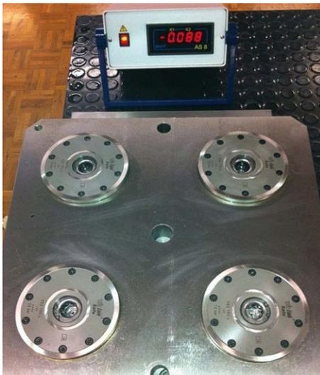
4 Kolben auf Lösestellung Hydraulik an, Restölinhalt ca. 88 cm<sup>3</sup>
