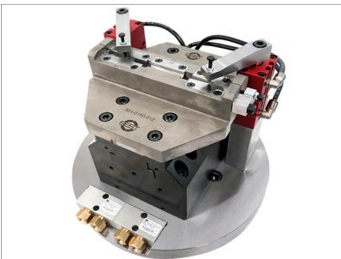
BSP-160 Sonderspannvorrichtung für Pinzettenspannung. Palette mit Druckerhaltung. Die Schwenkspanner dienen zur Vibrationsminderung.
