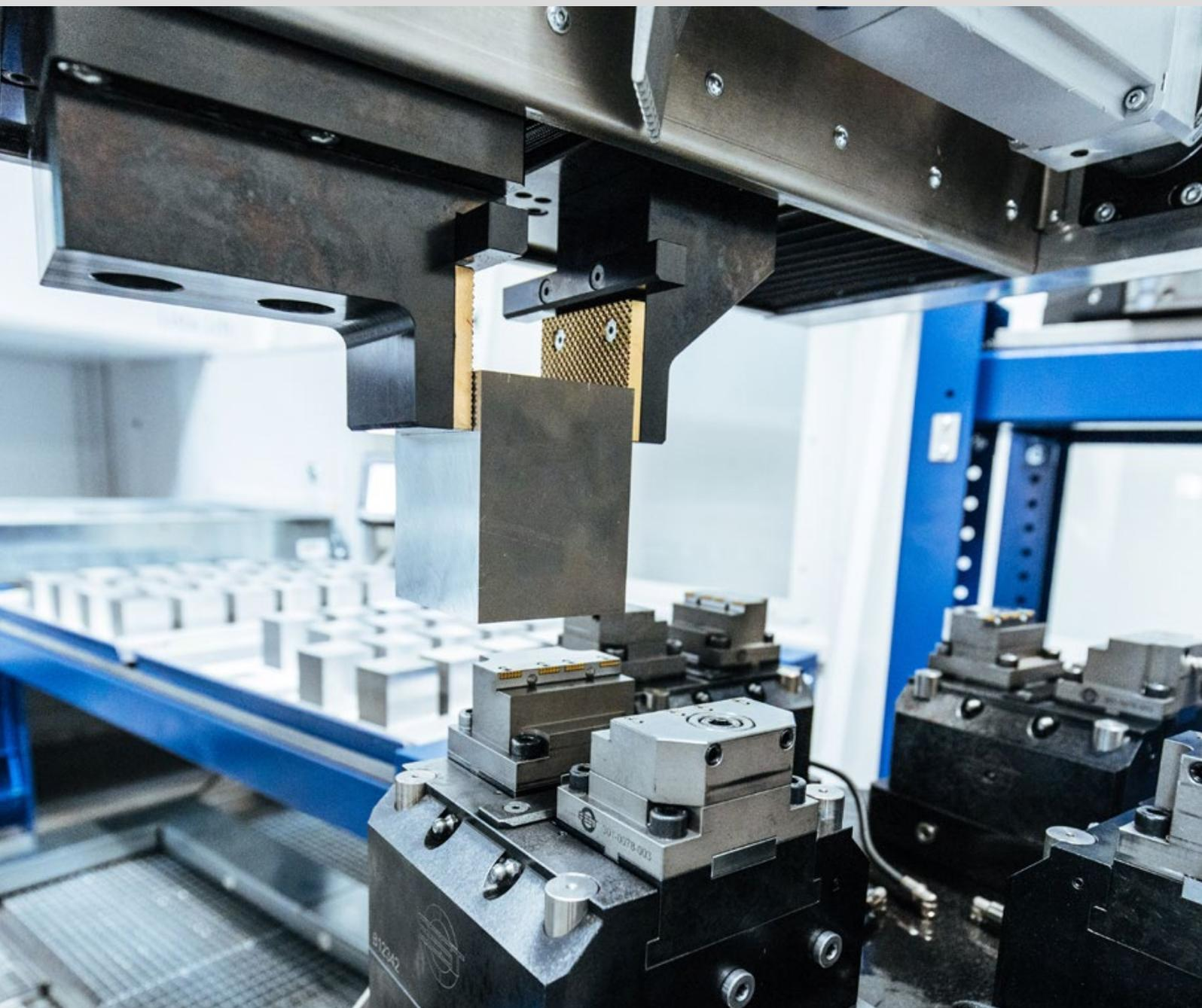
VBA Profi Line Zentrumspanner mit OP10 Pendel-Master-Grip Backen und Werkstück-Anlagekontrolle
