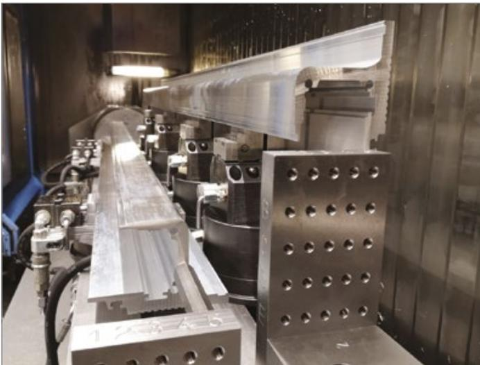
4 Stück BSH-100-FR spannen ein Profil von Innen nach Außen. Die Spanner haben eine Federrückstellung. Hier die Abbildung MIT Werkstück.
