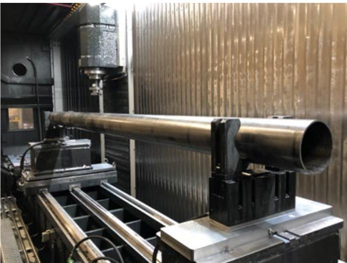
2 Stück BSH-290 spannen eine Welle. Der Spanner und die Backen wurden für den Kunden auf seine Anforderungen entwickelt. Gefordert war ein möglichst großer Hub. Mit dem BSH-290 können 15 mm Hub pro Backe realisiert werden.
