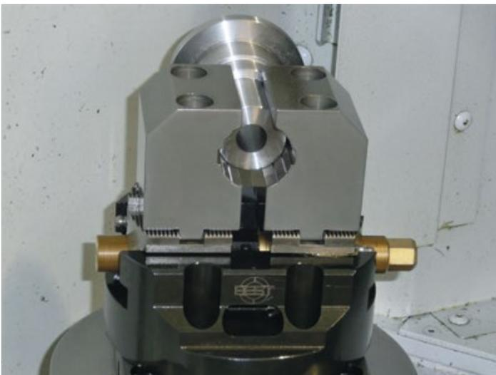
BSM-140 mit Formbacken (kundenspezifisch) zum Spannen eines Drehteils mit 35 mm Durchmesser.
