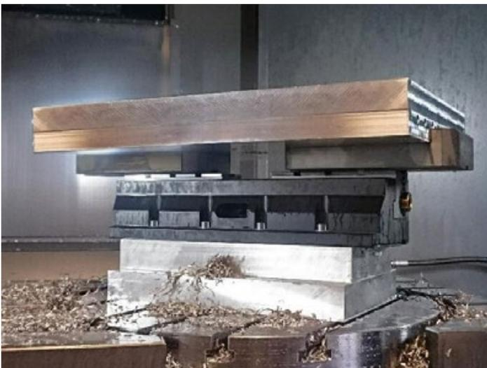
BSM-500 mit überstehenden Backen zum Spannen von Werkstücken bis 636 mm. Der Spanner ist auf einer Erhöhung angebracht, für die optimale Zugänglichkeit bei der 5-Achs-Bearbeitung.
