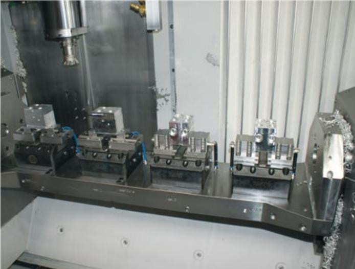
4 Stück BSH-160 auf einer Schwenkbrücke mit werkstückspezifischen Backen. Auf zwei Spannstellen erfolgt die Bearbeitung der OP10, auf der anderen die OP20.
