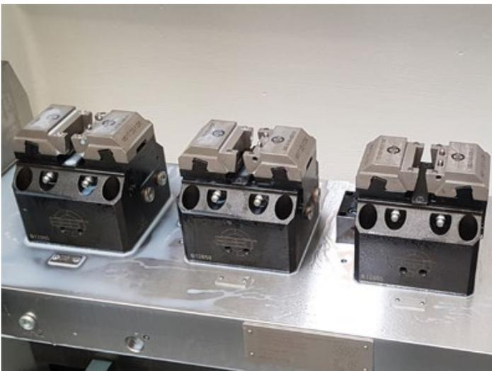
Voll automatisierbare Spannlösung für wechselnde Werkstücke. Durch die Klickbacken-Schnittstelle können die Backen auch von einem Roboter getauscht und dadurch mannlos umgerüstet werden. Verbaut sind hier auf einer Schwenkbrücke 4 Stück BSH-100-KB mit werkstückspezifischen Backen.
