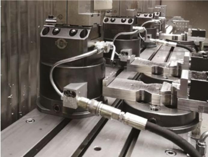
4 Stück BSH-100-FR spannen ein Profil von Innen nach Außen. Die Spanner haben eine Federrückstellung. Hier die Abbildung OHNE Werkstück.
