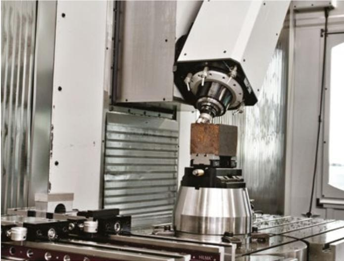
BSM-250 auf einer 5-Achs-Erhöhung für eine optimale Zugänglichkeit bei der 5-Achs-Bearbeitung.
