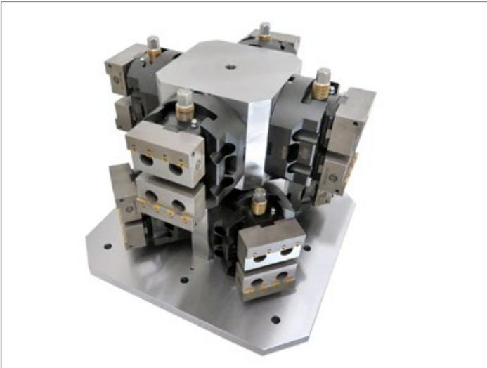
8 Stück BSM-140 mit Gripbacken auf einem Spannturm. Bei der kundenspezifischen Vorrichtung wurde die untere zur oberen Ebene versetzt angeordnet um Höhe zu sparen, da auf der Maschine nur begrenzt Verfahrweg in Z-Richtung vorhanden ist.
