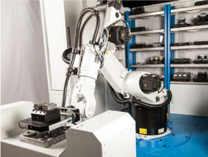
Automatisierte Anwendung des BSH-160 mit Pendelgrippbacken auf Palette. Spanner, Werkstück und Werkzeug können in der Vischer & Bolli Roboterzelle mit dem Roboter aus dem Magazin getauscht werden.
