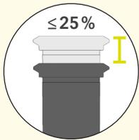
PGST ist bis zu 25% kürzer als das konventionelle PG-System. Normschäfte können vollständig eingesteckt werden.
