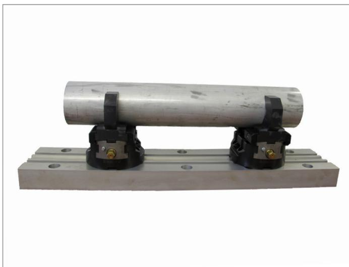
2 Stück BSM-140 mit Prismenbacken spannen eine Welle. Die Spanner können dabei wahlweise auf der Grundplatte verschoben werden. Somit können Wellen mit verschiedenen Längen und Durchmesser gespannt werden.
