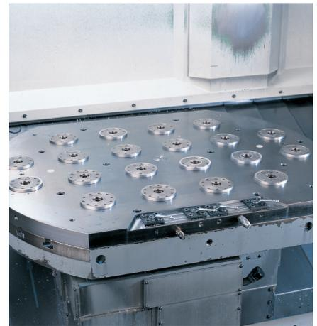
Spannmittel / Vorrichtungen mit Spannbolzen versehen
