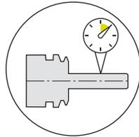
Rundlaufgenauigkeit  $\leq 10\mu\text{m}$  bei 3xD.
