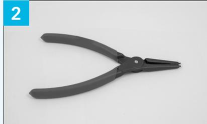
2 Mit Zange Sicherungsring demontieren.
