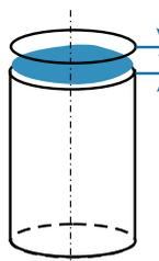
**Ebenheit** Die Toleranzzone wird durch zwei parallele Ebenen vom Abstand  $t$  begrenzt, deren Abmessungen denen der tolerierten Fläche entsprechen. Die reale Werkstückfläche muss zwischen beiden parallelen Ebenen vom Abstand  $t$  liegen.
