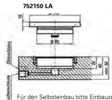
Für den Selbsteinbau bitte Einbauzeichnung verlangen! Max. Betriebsdruck 70 bar.
