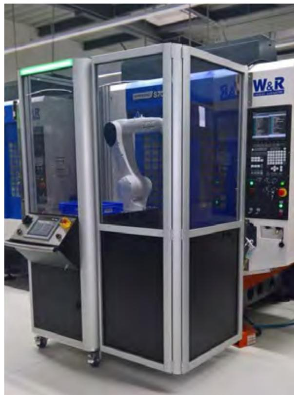
Mobile Roboterzelle (frontseitig) an einer Brother Maschine
