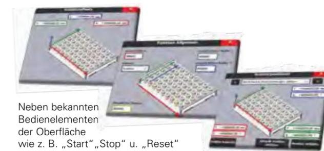
Neben bekannten Bedienelementen der Oberfläche wie z. B. „Start“ „Stop“ u. „Reset“ lassen sich durch die konsequent parametrisiert aufgebaute Software unter anderem auch Positionen zum Abholen oder Ablegen der Bauteile anpassen und ändern.
