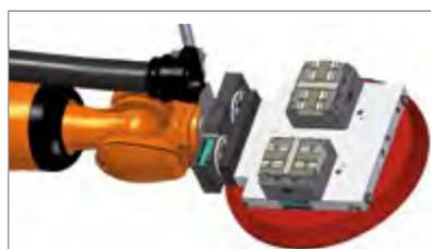
Roboter mit Vorrichtungspalette
