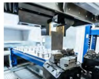
Elektrische Greifer für Werkstücke
