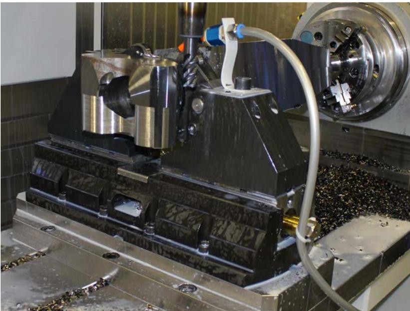
BSM-500 als Lynette. Das Werkstück wird mit einem 3-Backen-Futter gespannt, der Zentrischspanner dient rein zur Spannunterstützung.
